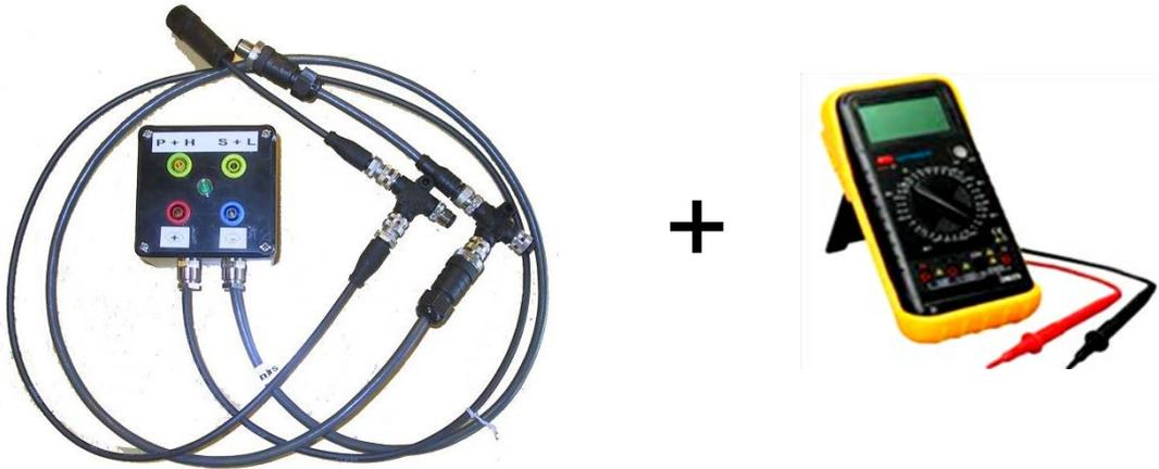
Se desmonta el enchufe M8/M12 del sensor/la electroválvula que se desea diagnosticar y se monta la caja de diagnóstico entre el enchufe y sensor/CAN con el cable suministrado. Al conectar los enchufes M8 se usan los cables adaptadores M8-M12 suministrados.
